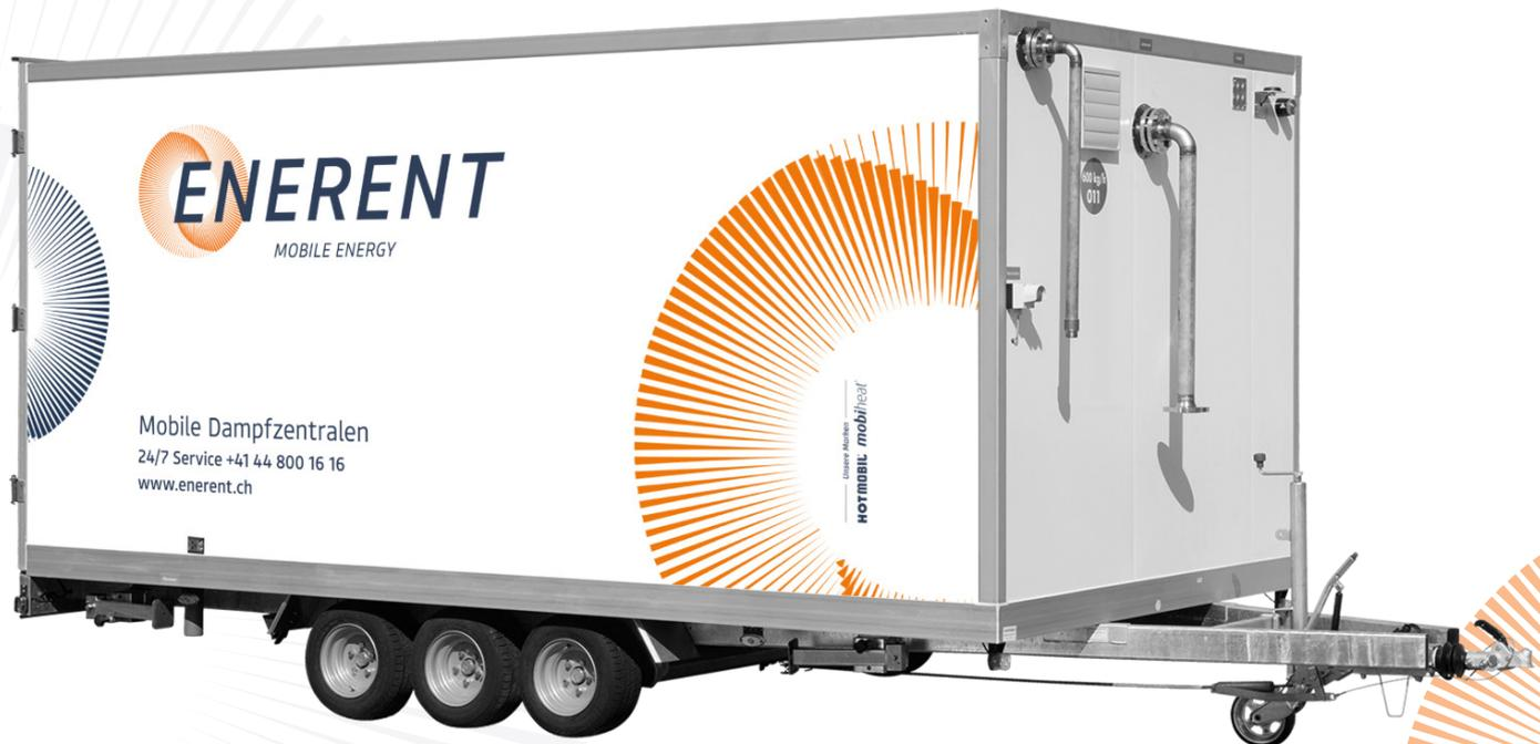
Die mobile Dampfzentrale MDZ 600 ist ein fahrbarer und sofort betriebsbereiter Schnelldampferzeuger auf einem Tandemanhänger für den mobilen Einsatz und autarken Betrieb. Die Anlage ist ausgestattet mit Wasserservicemodul, Wasseraufbereitung, Härteüberwachung, Automatikstarteinrichtung für autom. Betrieb und Ausserbetriebnahme, Wasserprobekühleinrichtung und automatischer Chemikaliendosierung. Unsere mobilen Dampfzentralen sind alle nach neuestem Stand der Technik entwickelt und mit Kessel
