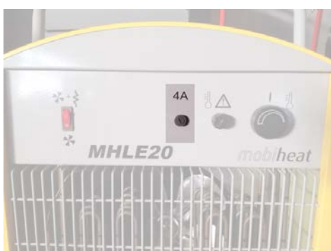
Bild: Bedienfeld Feinsicherung
